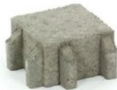
Viherässä 100 x 291 x 305, Helsingin kaupungin kanssa kehitetty reikäkivi erityisesti raitiotiekiskoille.
